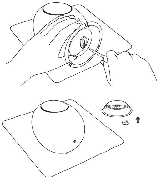
3. 革ベルトの両端の穴を合わせて保管して置いたねじを通し、さらにワッシャーを通してスピーカーにネジ止める。(しっかりとネジ止めされていることを確認してください)
