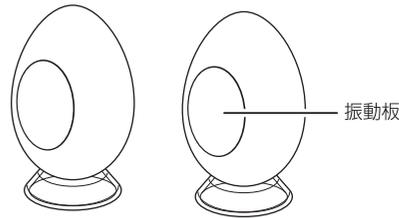
2. スピーカーから台を外しねじを保管する。(このねじは、革ベルトを装着するために使用しますので、無くさないでください)
