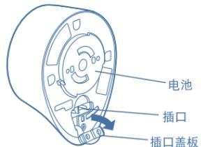
**③ 将电源适配器连接到电池和插座。**
