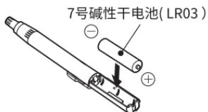
**③ 将电池盖的槽口部吻合开关部的位置槽口部牢固的插进最里面。**
