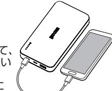
2. 充電の状態は、接続した機器の充電表示でご確認ください。出力端子は、接続した機器が満充電になり電流が約0.1A以下になると出力が自動停止し、LEDが消灯します。(接続した機器によって、満充電になる前に自動停止することがあります。また、満充電になつても自動停止しないことがあります。)
