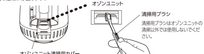
\*取り付け、取り外しの際、指をはさんだり、けがをしたりしないようご注意ください。●オゾンユニットを傷つけないようにしてください。●オゾンユニット清掃用カバー、フィルターは確実に取り付けてください。取り付けが不十分だと、動作不良や故障の原因となります。●フィルターを破らないように注意してください。
