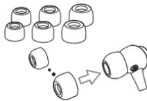
お買い上げ時には、Mサイズのイヤーピースが装着されています。Mサイズが耳に合わない場合は、付属のSサイズまたはLサイズに交換してください。イヤーピースが合っていないと耳の穴を隙間なく密閉することができず、音漏れや低音が聴こえない原因になります。音量が小さいと感じた場合は音漏れの可能性があります。
